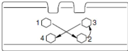
Verifique los tornillos de las placas de las orugas todos los días. Si los tornillos (A) de las placas de las orugas están sueltos, la placa puede dañarse.
