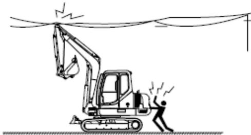
Las personas pueden ser alcanzadas por descargas eléctricas si la máquina está próxima a cables de alta tensión.
