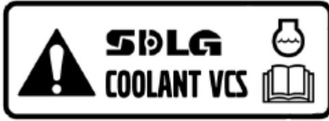
**¡Importante! El VCS no puede mezclarse con otro líquido refrigerante u otra protección contra corrosión ya que el motor se dañará.**
